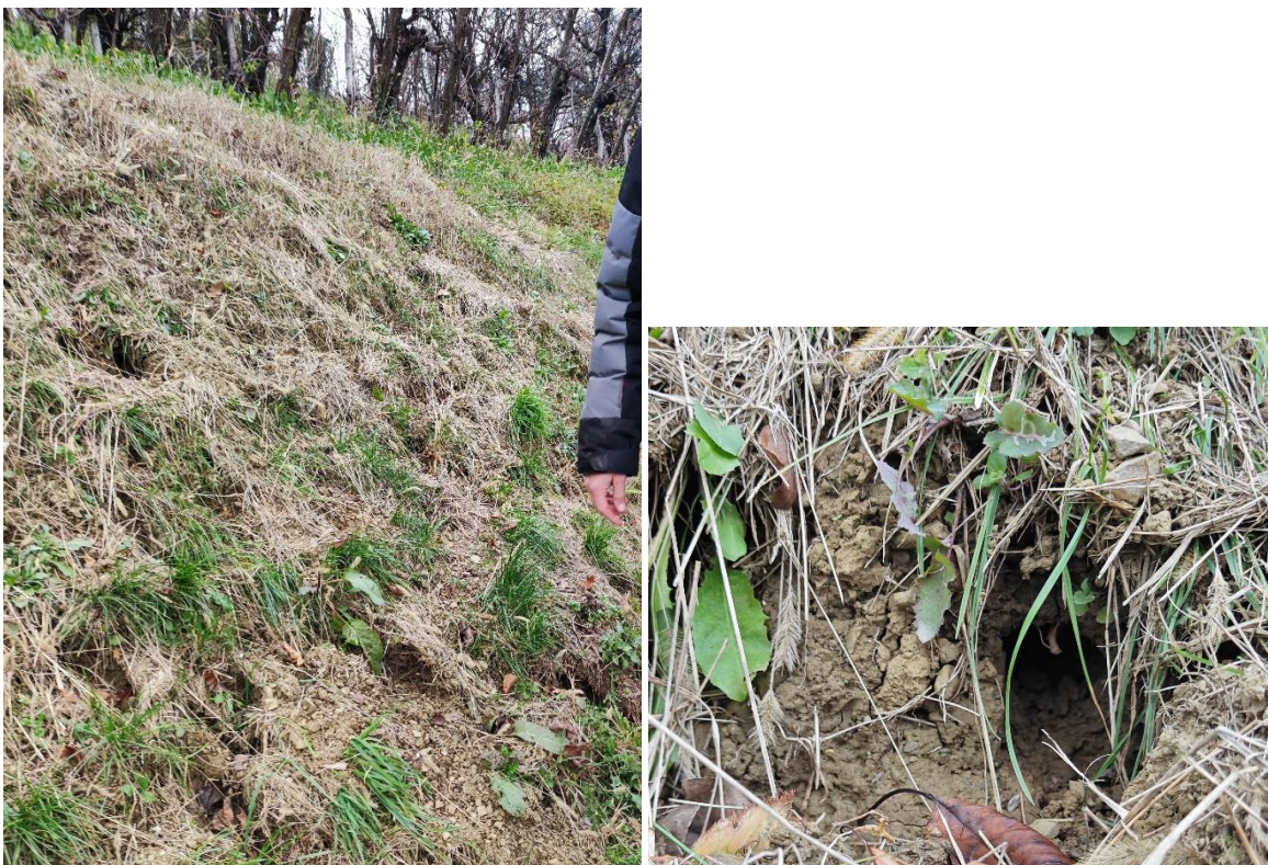
Slika 11: Posebni pojav nad plazom pri vrtu – verjetno sufuzijski kanali, zaradi spiranja.
