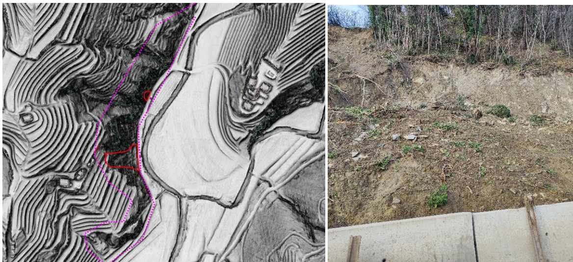
Slika 13 (leva slika): Širše območje fosilnega plazenja in erozije – vijoličen poligon in skica aktivnih plazov rdeči poligoni.
