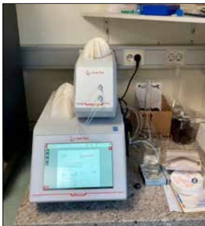
Oenolab encimatski analizator OE-300: merjenje glukoze, fruktoze oziroma s pravilnim izborom encimskim kompletom lahko izvaja mo analize številnih drugih spojin, vključno s saharozo, organskimi kislinami, glicerolom, acetaldehidom, fenolnimi spojinami ipd.
