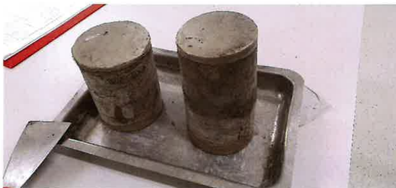
Slika 2: priprava preskušancev – izravnava čelnih ploskev
