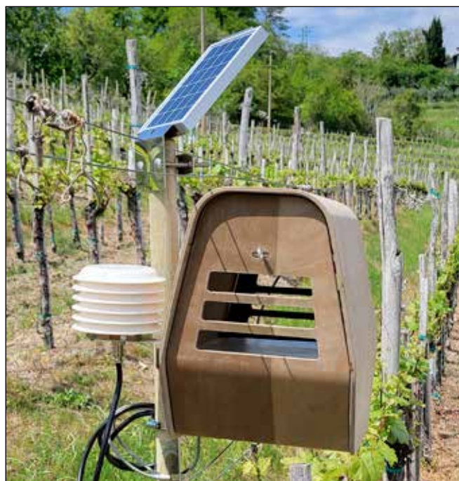
Avtomatska past za škodljivce Trapview nove generacije, izdelana iz lesa, ki sledi trajnostni zavezanosti podjetja EFOS.
