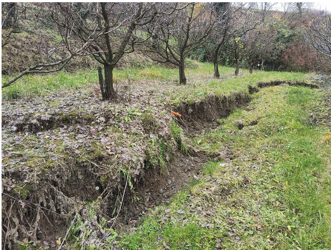
Slika 10: Sekundarne odlomne razpoke v sadovnjaku.
