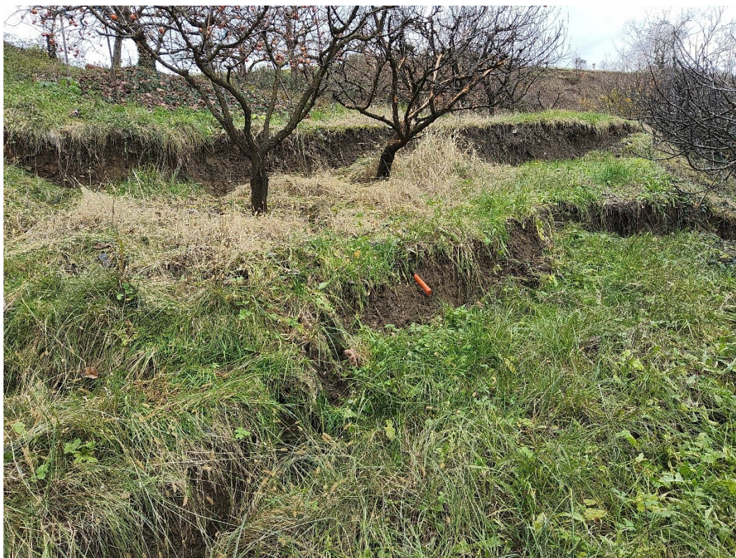
Slika 9: Sekundarne odlomne razpoke v sadovnjaku.
