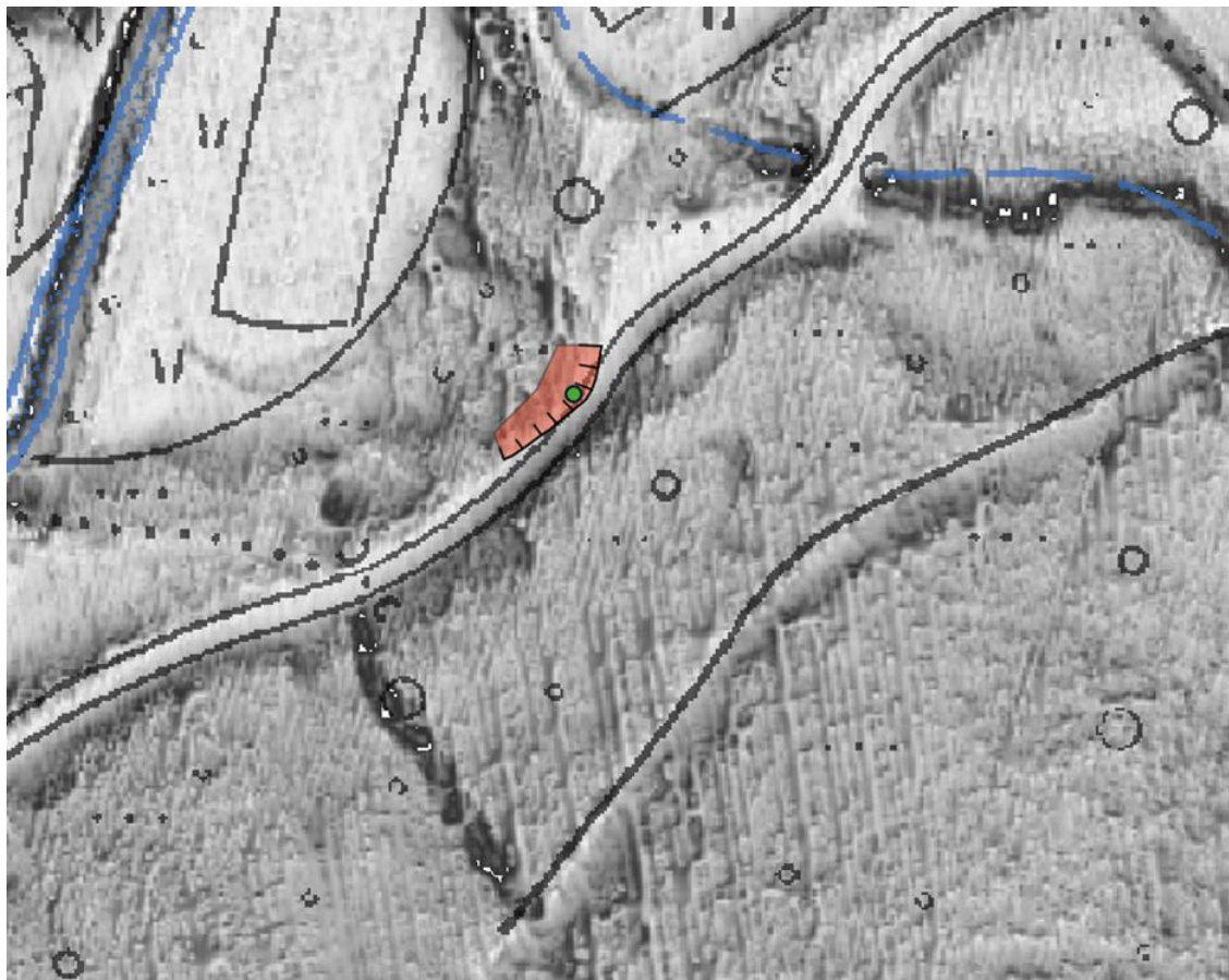
Slika 2: Skica plazu na lidar in TTN5 podlagi. Rdeč poligon – plaz zgornji del, Zeleni krožec – predlog lokacije vrtine.
